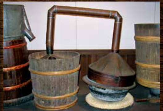
宮崎市大島町で使われていた蒸留器。左の樽に入っている器具が井之川で見つかったものと同じもの。（薩摩酒造明治蔵所蔵）
