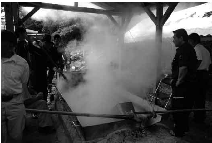
サタヤドリ（砂糖小屋）で、昔ながらの製法でキビ汁を煮詰めています。
